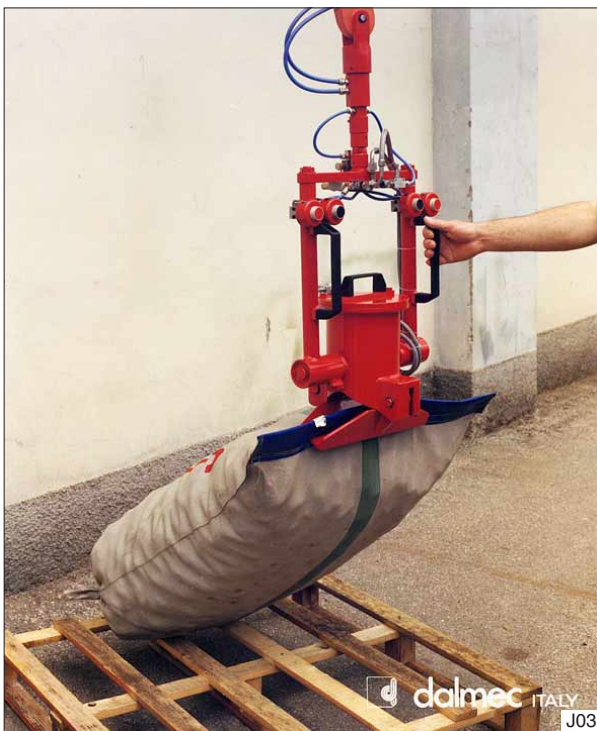
Zakken staand opnemen en liggend op een pallet plaatsen. Met de Dalmecc Partner balancer wordt het kinderspel.
