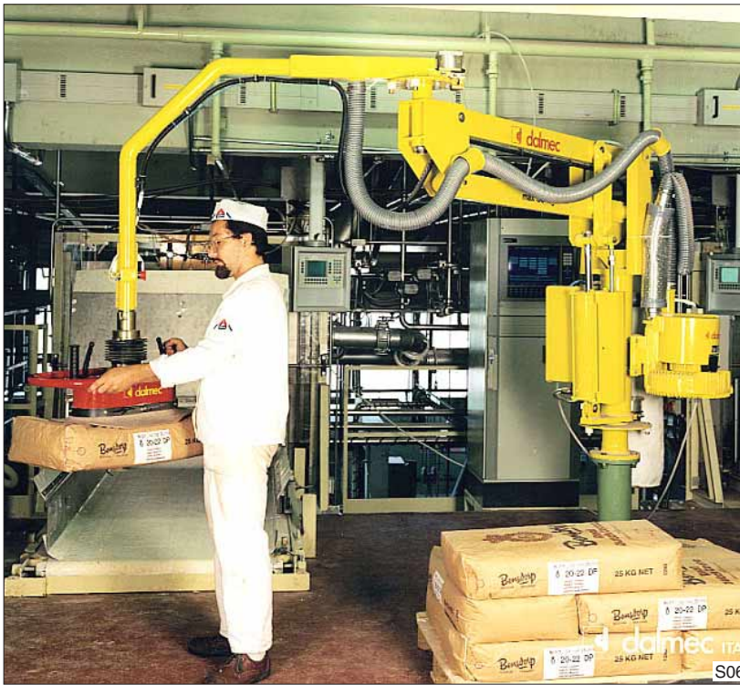
S07 Lastopnemer voor het opnemen van zakken, uitgevoerd in RVS.
