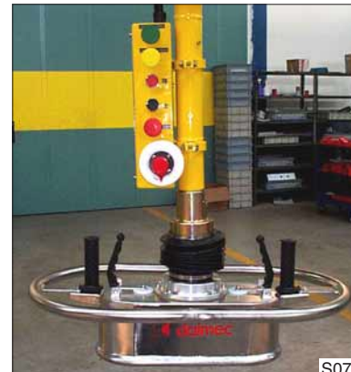
S07 Lastopnemer voor het opnemen van zakken, uitgevoerd in RVS.
