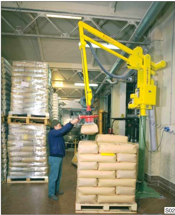
Het pallettiseren of depallettiseren van zakken tot een stapelhoogte van ruim twee meter is mogelijk door de vacuüm lastopnemer uit te voeren met een verlaagde bediening.
