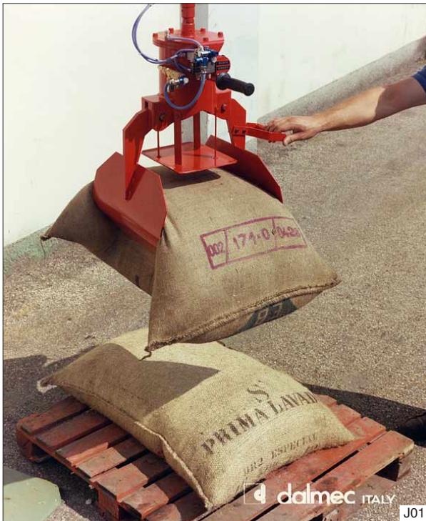
Wanneer toepassing van vacuüm niet mogelijk is voor het opnemen van de zakken kan gebruik gemaakt worden van een pneumatische klem.
