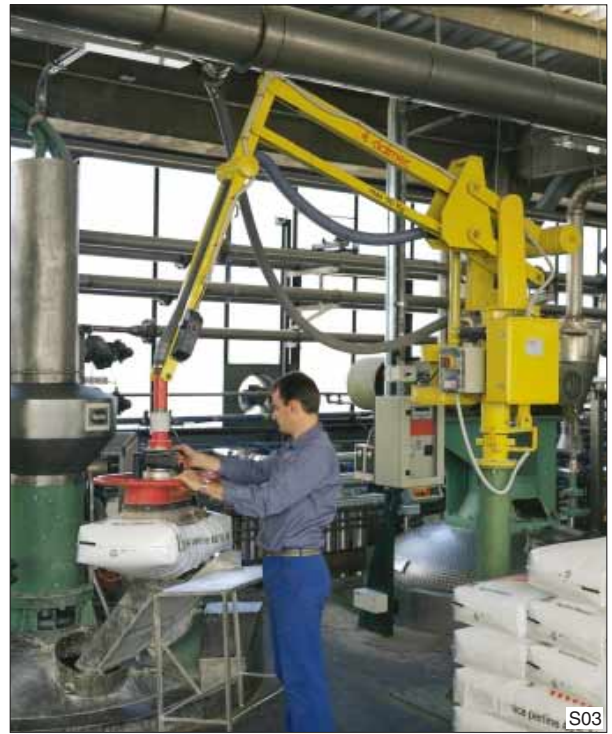
Zakken opnemen van een pallet en plaatsen op het aflegplateau van een mixer. Dankzij de schijnbare gewichtloosheid is het met de Partner balancer kinderspel.
