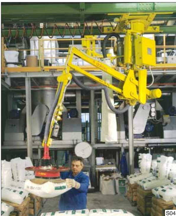
De Dalmec Partner in de hangend verrijdbare uitvoering. Dankzij het grote werkgebied kunnen de zakken van verschillende afvalposities opgenomen en weggezet worden.
