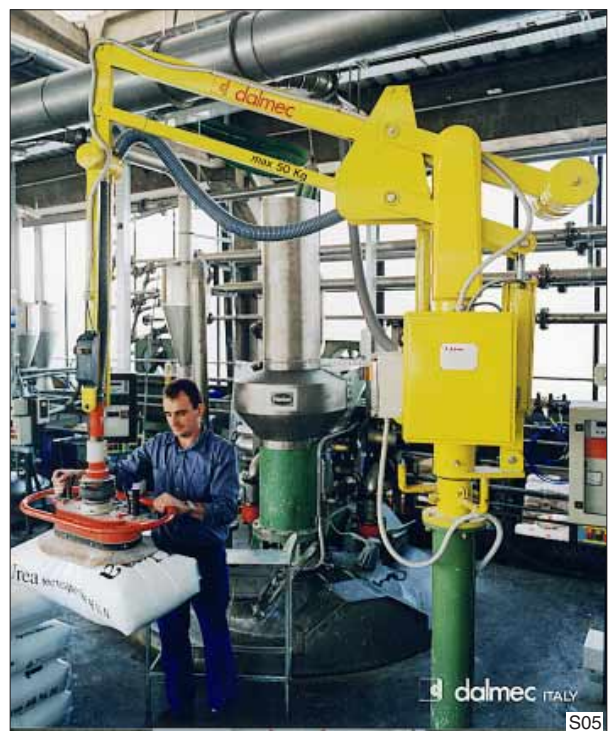
Zakken tot 50 kg. moeiteloos opnemen van een pallet en op het afzetplateau van een mixer plaatsen.
