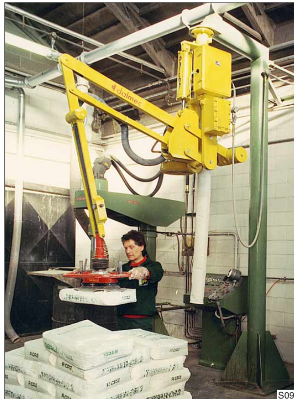
S09 De Partner balancer in hangende uitvoering met een speciale 'galg-constructie'.
