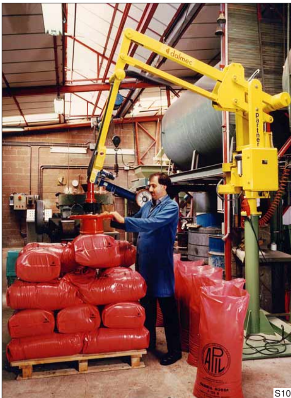
S10 Het palletiseren van plastic zakken aan het einde van de productielijn met de Dalmeccan Partner in kolomuitvoering.
