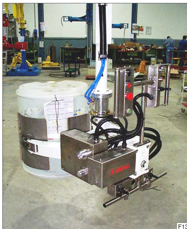
Het opnemen van vaten met agressieve stoffen is met behulp van de Dalmec balancersystemen mogelijk. De RVS klembekken zijn bestand tegen zuren en vele andere stoffen.
