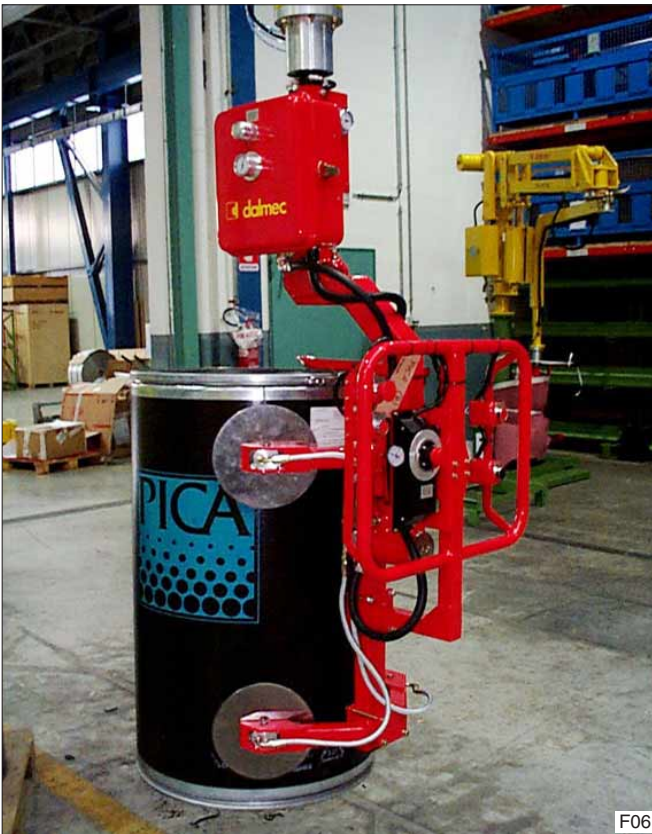
Vaten opnemen met vacuüm aan de buitenzijde van het vat.
