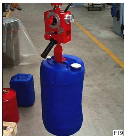
Voor het opnemen en palletiseren van afgevulde emmers wordt hier gebruik gemaakt van het balancersysteem type Posivel .
