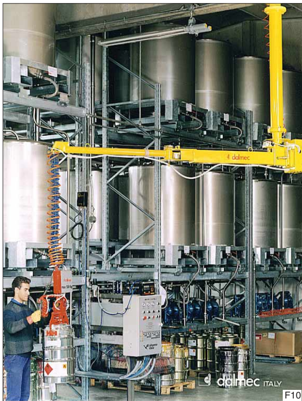
Posifil balancer in hangende uitvoering. Een groot werkbereik terwijl het vloeroppervlak geheel vrij blijft.
