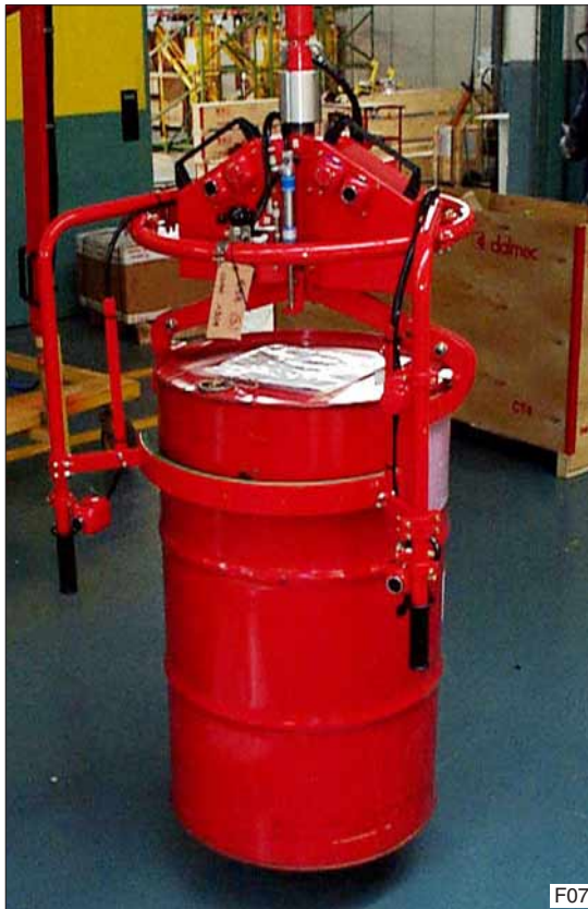
Vaten onder de rand van het vat klemmen en tot maximaal twee lagen stapelen. De verlaagde bediening zorgt ervoor dat lossen altijd mogelijk is op verantwoorde hoogte.
