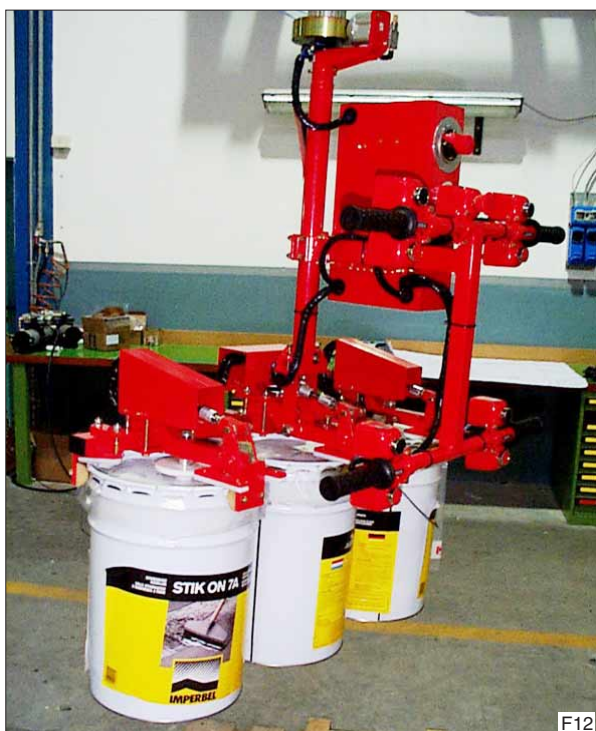
Drie vaatjes tegelijkertijd klemmend opnemen. De dubbele bediening maakt klemmen op vloerniveau en lossen op hoger niveau mogelijk.
