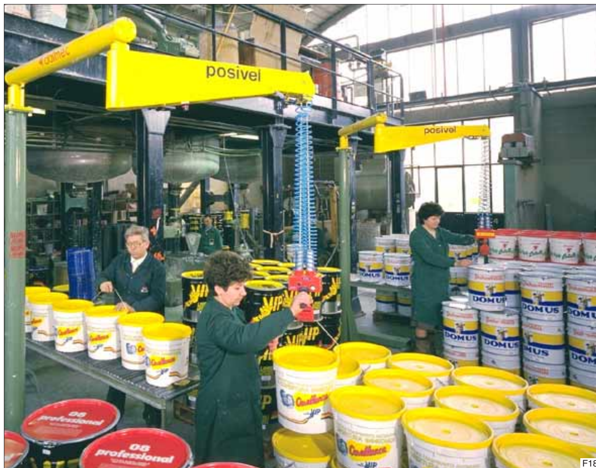
Voor het opnemen en palletiseren van afgevulde emmers wordt hier gebruik gemaakt van het balancersysteem type Posivel .
