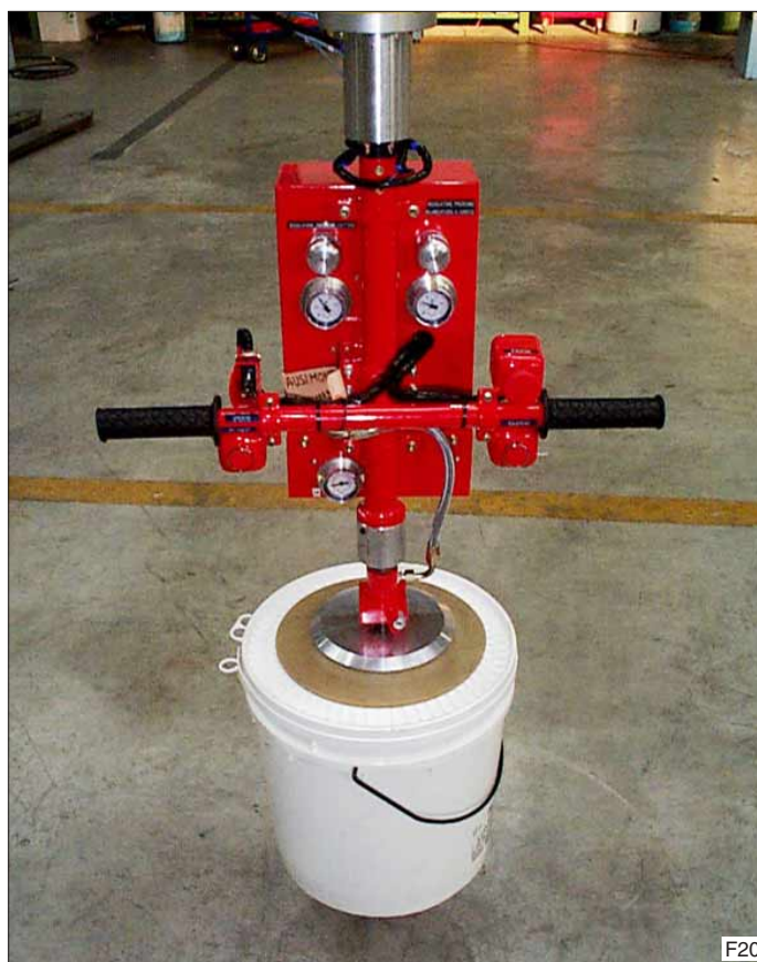
Emmers met één enkele zuigschaal opnemen aan de deksel.
