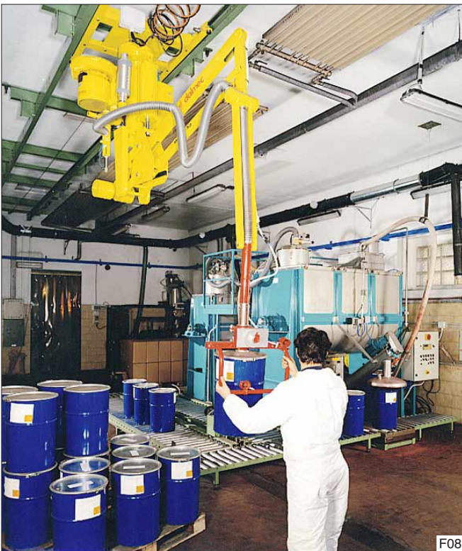
Partner balancer in hangende uitvoering voor het opnemen van emmers bij de afvullijn. Opname gebeurt met één vacuüm-zuigschaal aan het deksel.
