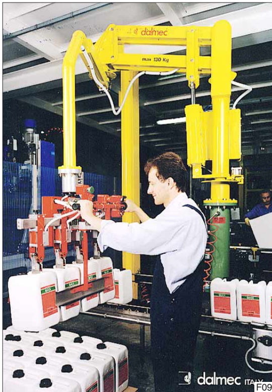
Vier jerrycans tegelijkertijd opnemen met de Partner balancer. De vier pneumatische klembekken van de lastopnemer zorgen voor een veilige en snelle handling.
