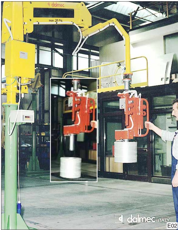
Dalmec Partner balancer in kolomuitvoering voorzien van spandoorn en kantelcilinder. Een speciale weegunit controleert het gewicht van de opgenomen klos.
