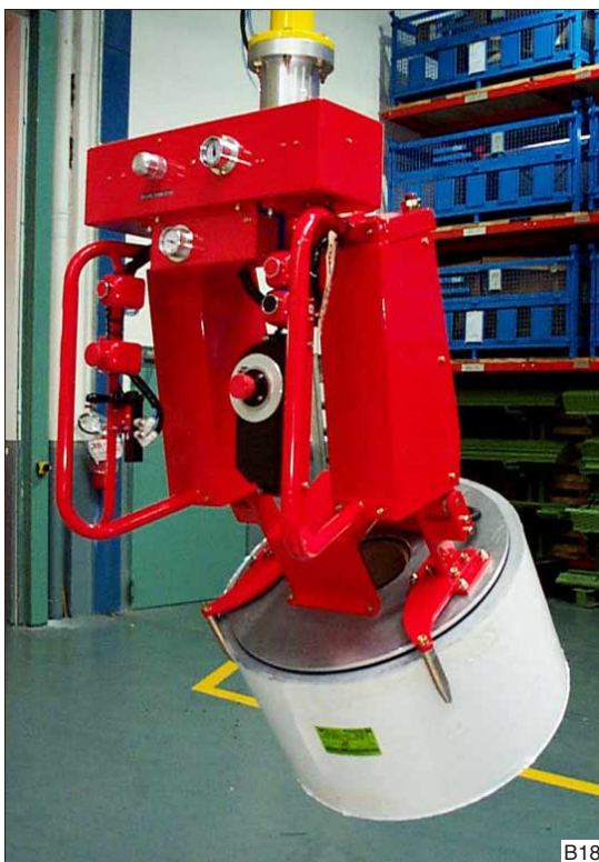
Een lastopnemer voor het pneumatisch kantelen van rollen. Ideaal voor het opnemen van rollen van een wikkelas en plaatsen op een pallet.
