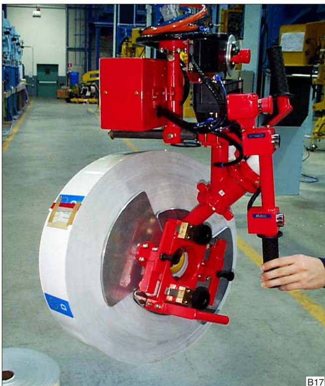
Rollen opnemen met vacuüm en handmatig 90° kantelen. De constructie van de zuigschaal zorgt er voor dat de rollen ook direct van de as opgenomen kunnen worden.
