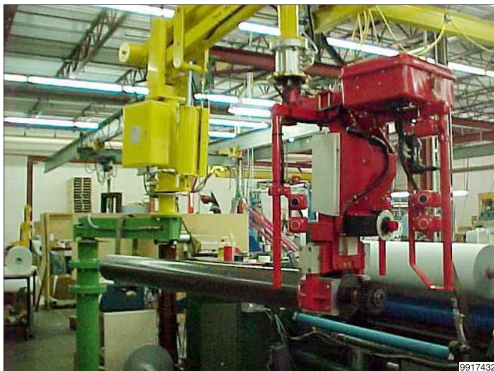
Dalmec Partner balancer uitgevoerd met een 'buitenassige kolom', waardoor een extra grote radius gerealiseerd wordt.
