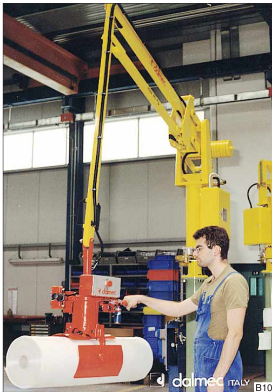
Partner balancer, type PSC, met een lastopnemer die de rol van bovenaf klemt en met het asgat horizontaal verplaatst.
