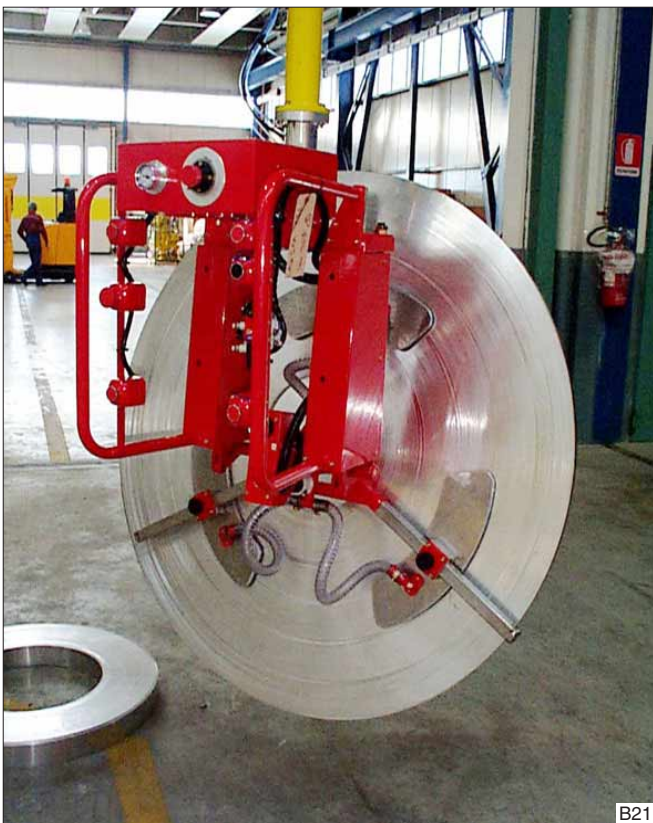
Smalle rollen staalband opnemen en kantelen. Met de Dalmec balancersystemen worden ook deze onhandelbare formaten te hanteren.
