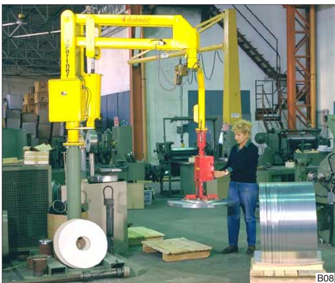
Wanneer klemmen in de huls of klemmen aan de buitenzijde van de rol niet mogelijk is, kan gebruik gemaakt worden van een vacuüm zuigplaat. Het vacuüm wordt verkregen door gebruikmaking van het 'venturi-systeem', waardoor uitsluitend perslucht nodig is. Een elektrische aansluiting is hierdoor overbodig.
