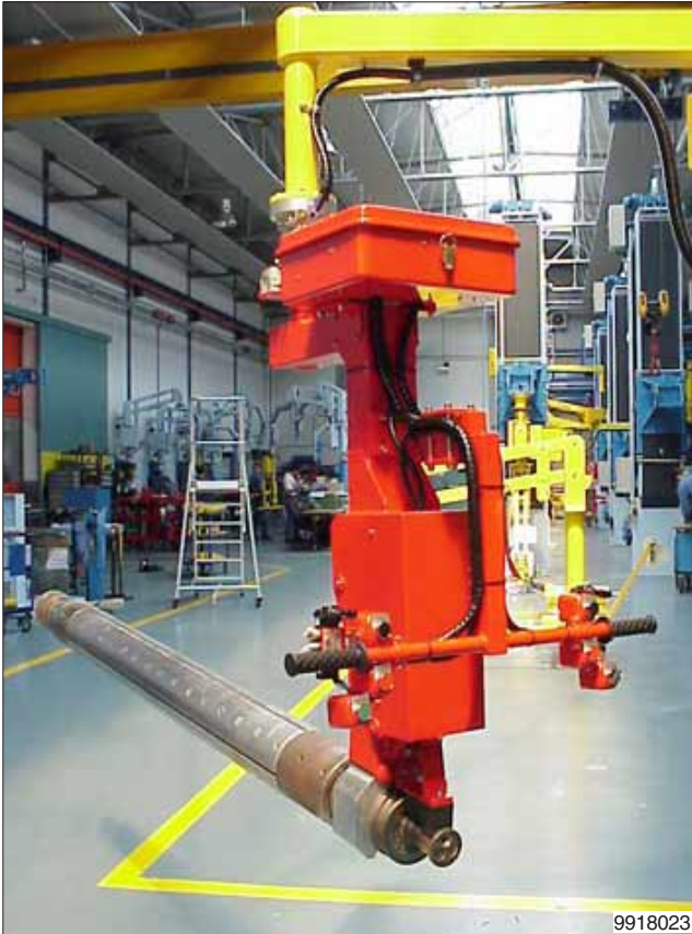
Een ingebouwde compensatiecilinder zorgt er voor dat de as altijd exact horizontaal hangt.
