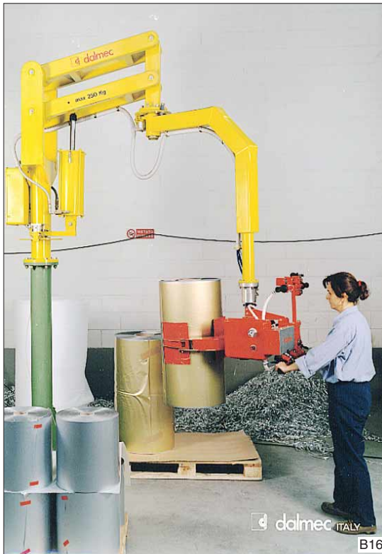
Dalmeccanica Partner balancer in kolomuitvoering voor het klemmen van rollen aan de buitenzijde. De rotatiecilinder maakt het mogelijk de rol +/- 90° te kantelen.
