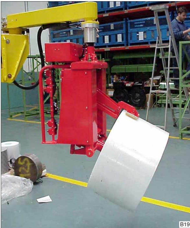
Een speciale 'anti-telescooper-voorziening' zorgt er voor dat de gewikkelde lagen niet afglijden bij opname in de huls. Het 'handje' kantelt mee met de rol.
