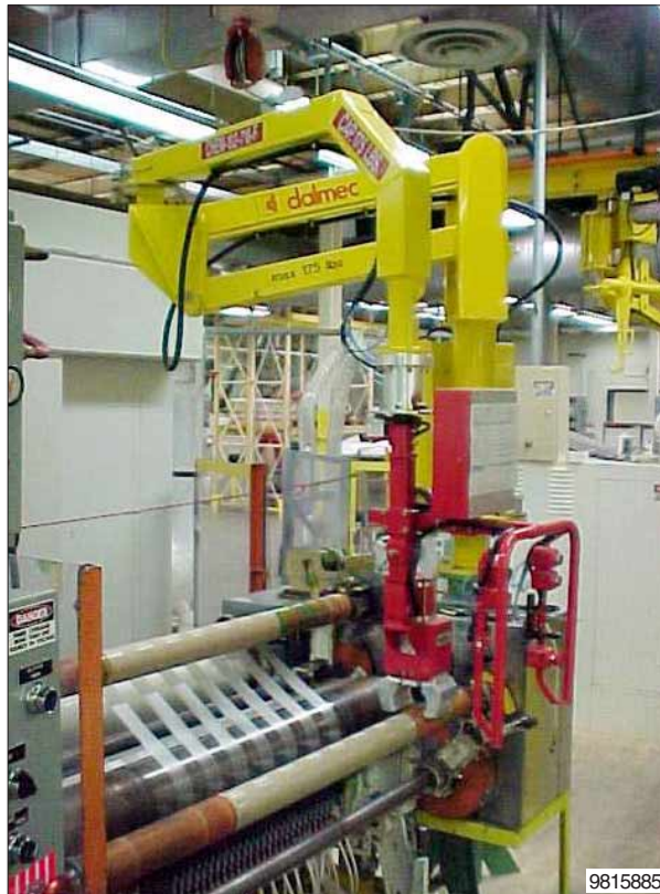
Dalmec Partner balancer in kolomuitvoering met een lastopnemer die ook assen met folie, pneumatisch klemmend, kan opnemen.
