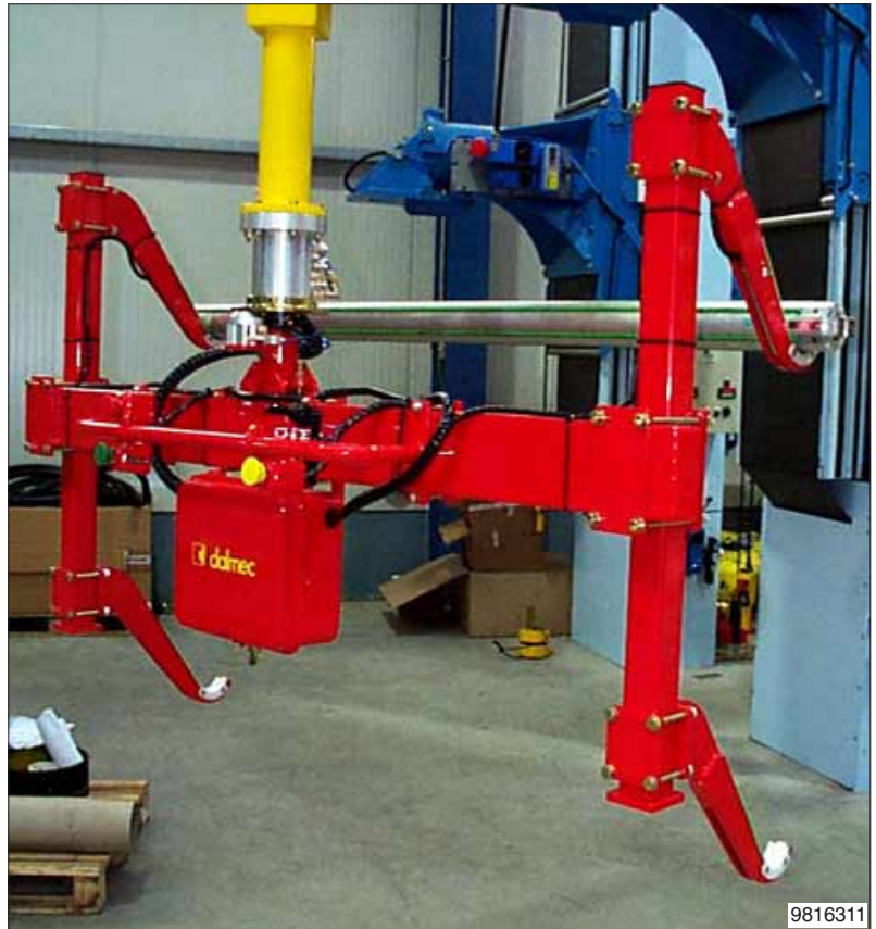
Een lastopnemer uitgevoerd met een dubbele set vorken, die de wikkelassen dragend opnemen.
