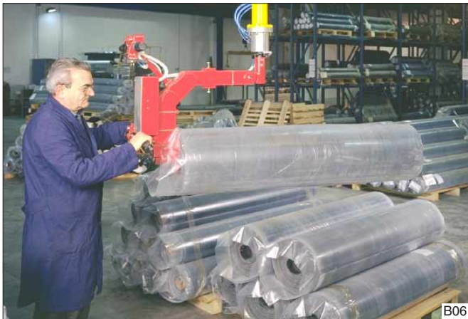
Zware rollen rubber mat dragend opnemen met een c-haak. De bediening is in de c-haak geïntegreerd.
