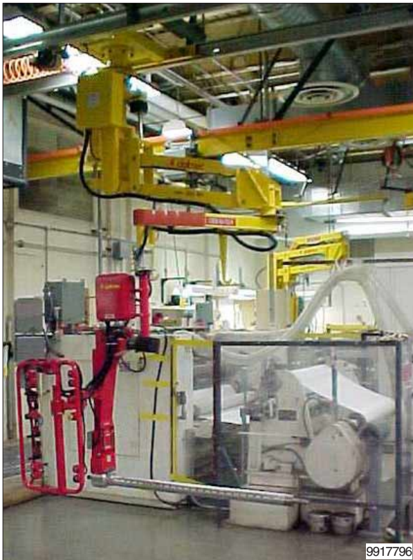
Dalmec Partner balancer in hangend verrijdbare uitvoering voor het opnemen van wikkelassen. De traversebaan met lorrie maakt het mogelijk beide zijden van de machine eenvoudig te bereiken.
