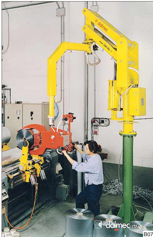
Rollen klemmend opnemen uit een snijmachine en 90° draaien om ze met het asgat verticaal op een pallet te plaatsen.
