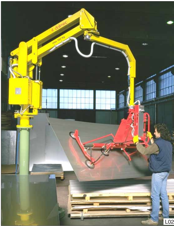
Dalmeccanica Partner in kolomuitvoering met een verplaatsbare voetplaat. Het geheel kan met behulp van een vorkheftruck verplaats worden en is hierdoor multifunctioneel inzetbaar binnen uw bedrijf. De balancer neemt de RVS platen op met vacuüm en kantelt deze pneumatisch 90°.
