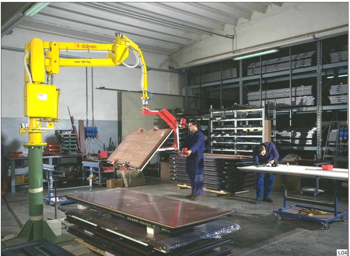
Dalmeccanica Partner balancer voor het opnemen van gepantserde deuren met behulp van twee sets zelfcenterende klembekken. De deur wordt met een rotatiecilinder 180° geroteerd. Zo is het mogelijk om beide zijden van de deur te inspecteren en/of te bewerken
