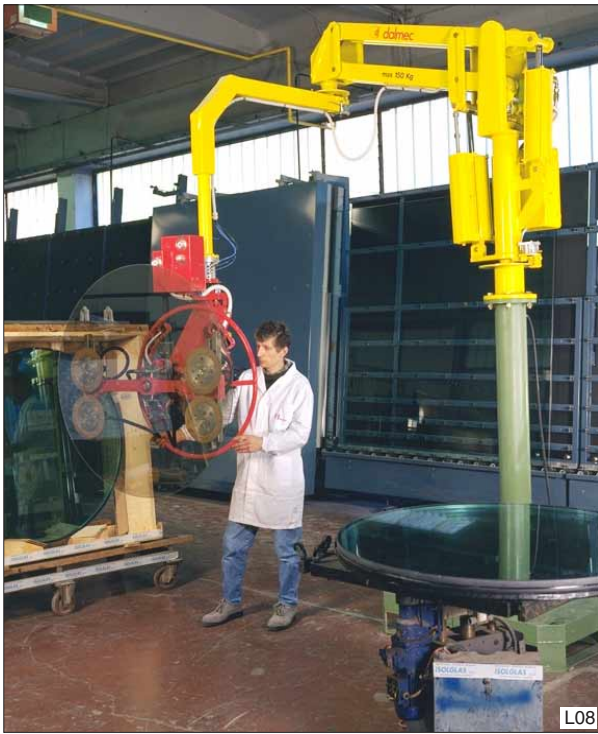
Glasplaten opnemen van een glaswagen en plaatsen op een werktafel en visa versa. Het kantelen gebeurt pneumatisch. Met de Partner wordt het handlen kinderspel.
