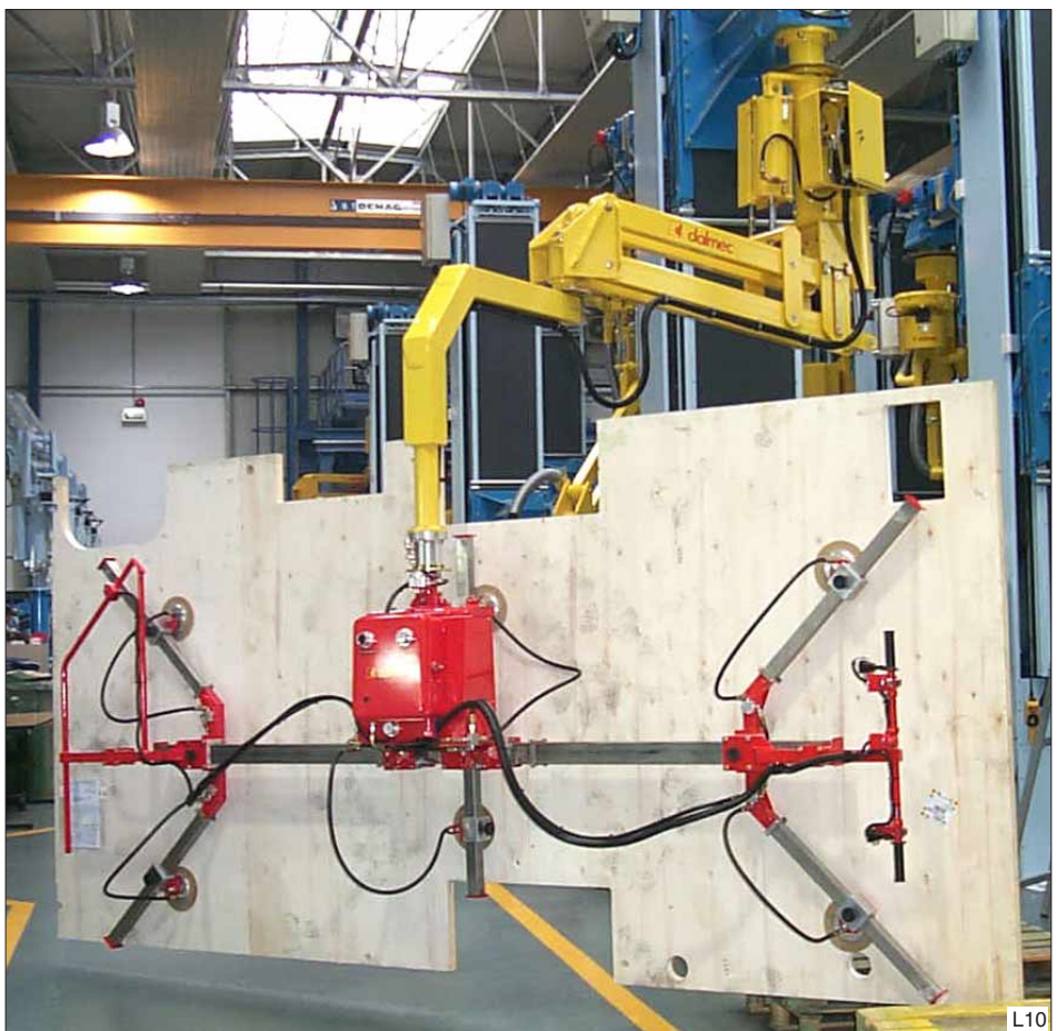
De complete vloer van een camper opnemen en 90° kantelen met deze Partner balancer in hangende uitvoering.
