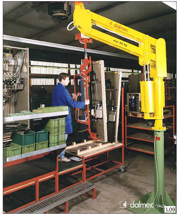
Deuren van koffieautomaten opnemen en schijnbaar gewichtsloos monteren met deze Dalmeccanica Partner balancer in kolomuitvoering.
