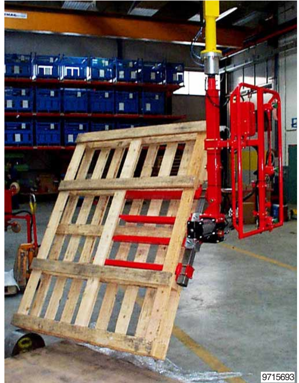
Lastopnemer met vorken, gemonteerd aan een Partner balancer. Het draaien van de pallet gebeurt pneumatisch met een dubbelwerkende rotatiecilinder
