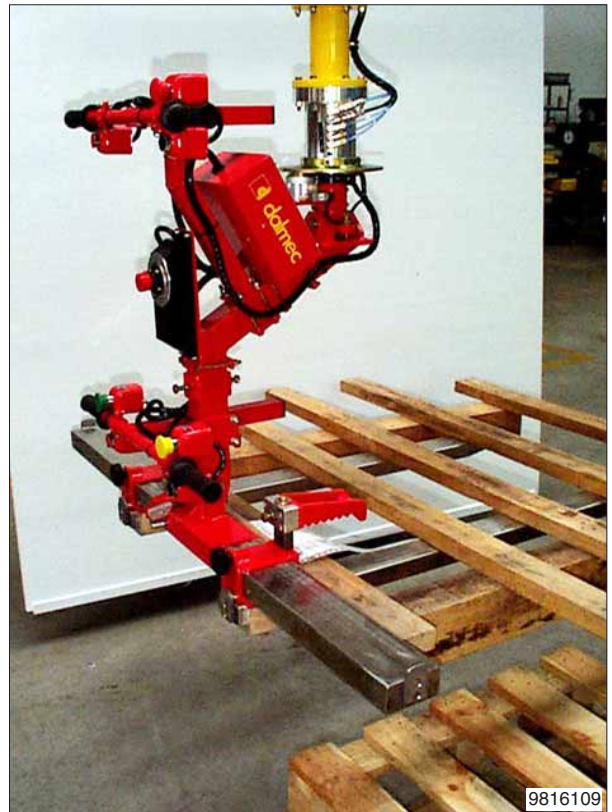
Het horizontaal verplaatsen van pallets wordt kinderspel met deze lastopnemer. De vorken zijn over een grote lengte verschuifbaar.
