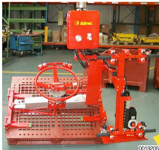
Dalmec Partner balancer voor het opnemen van bijna alle typen pallets. De lastopnemer klemt de pallets en maakt het mogelijk ze te kantelen en te draaien.
