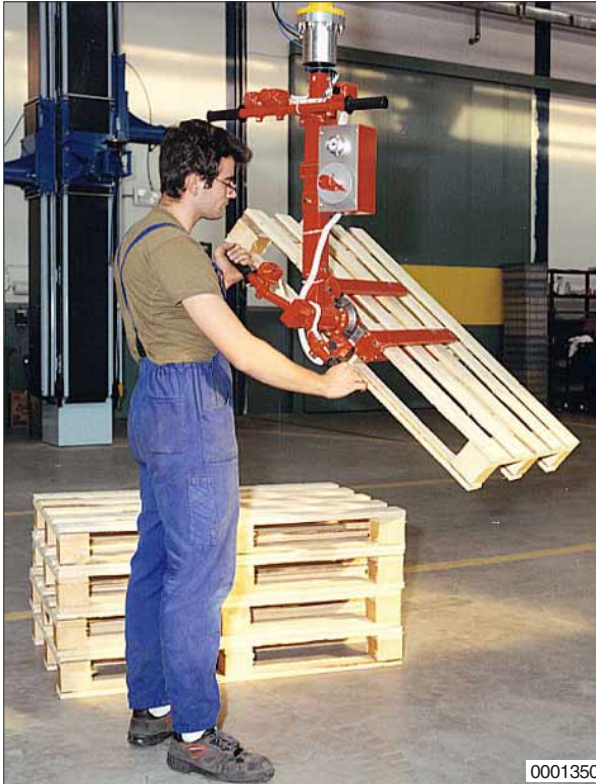
Een lastopnemer voor het opnemen en 180° draaien van pallets. Het draaien gebeurt handmatig.
