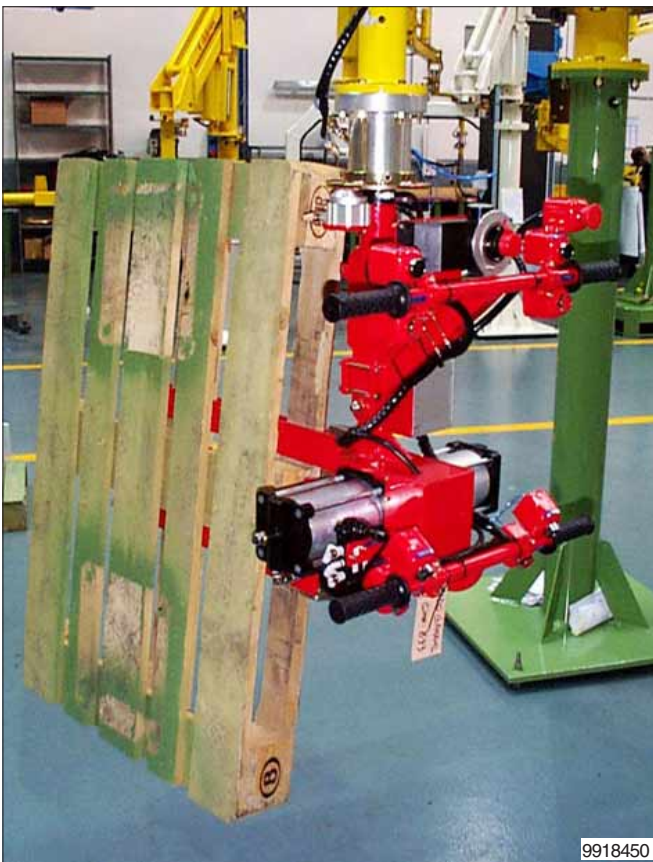
Pallets snel opnemen en draaien voor inspectie. Deze lastopnemer maakt het u gemakkelijk.
