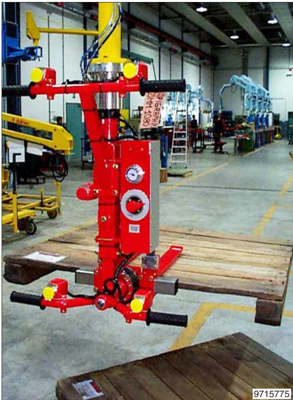
De verhoogde bediening zorgt er voor dat de pallets gemakkelijk op vloerniveau opgenomen of neergezet kunnen worden.
