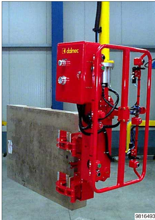
Lastopnemer met twee klembekken voor kunststof pallets.
