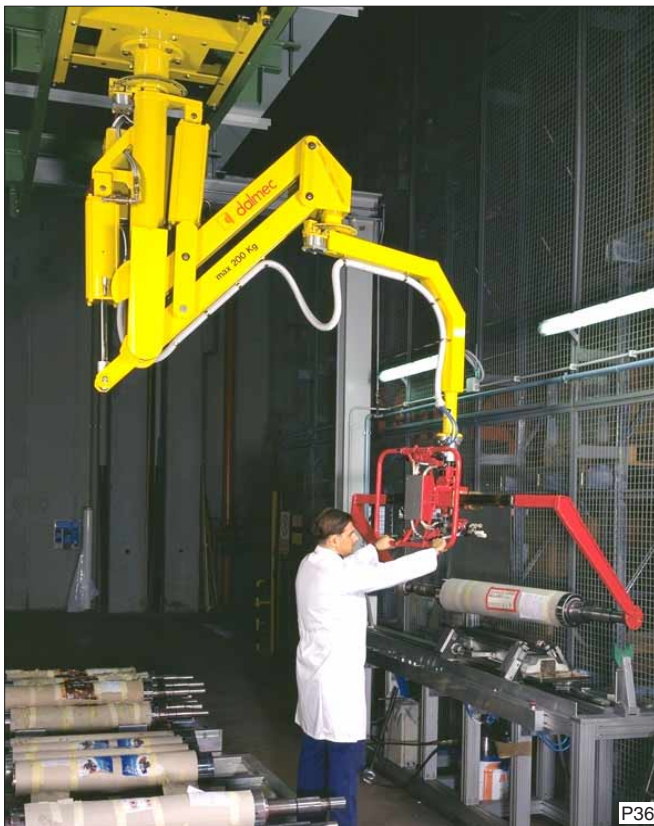
Partner balancer in hangende verrijdbare uitvoering voor het opnemen van cilinders. De lastopnemer is voorzien van twee klemmen, die het mogelijk maken de cilinders van een pallet op te nemen en op een bewerkingsmachine te plaatsen.
