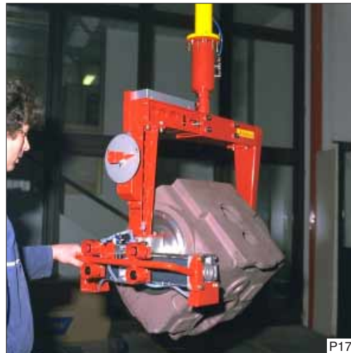
Gietstukken legen met een Dalmeccanica balancersysteem. Het onderdeel wordt aan twee zijden geklemd en pneumatisch gedraaid.
