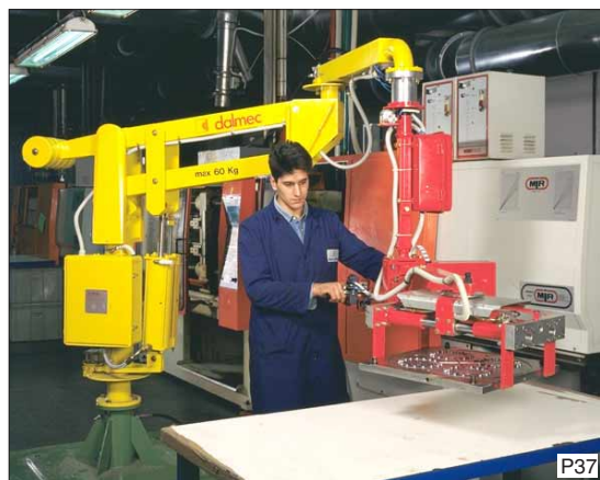
Een Dalmec Partner balancer in extra lage uitvoering voor het opnemen van vlakke platen bij een pers.
