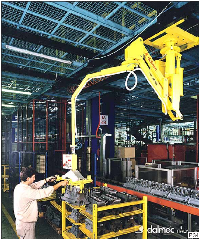
De automobiellndustrie is een dankbaar gebruiker van de Dalmec balancersystemen. Hier worden motorblok-onderdelen met een Partner balancer in hangende verrijdbare uitvoering opgenomen van een transportband.
