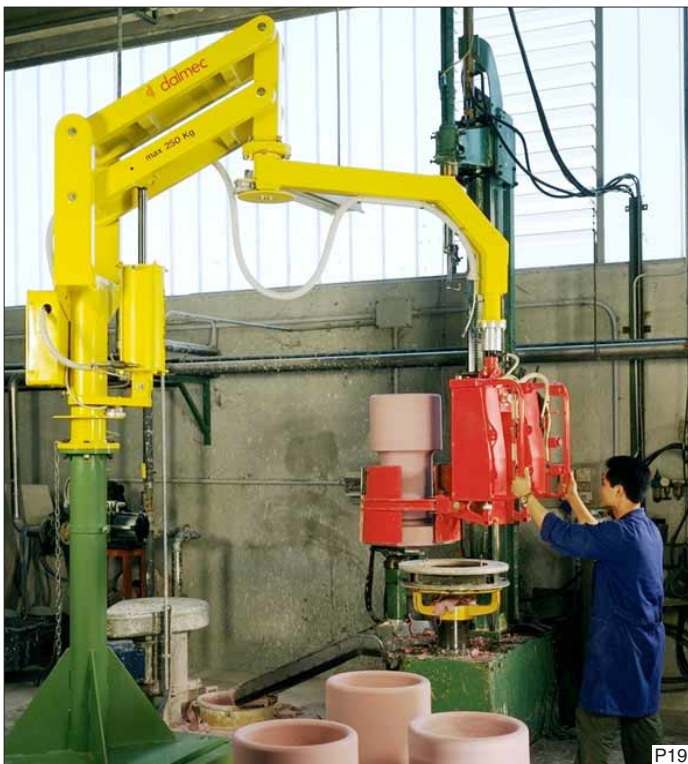
Keramische cilinders opnemen en 90° kantelen. Met de Dalmeccanica Partner balancer is het mogelijk. Zonder materiaalbeschadiging.
