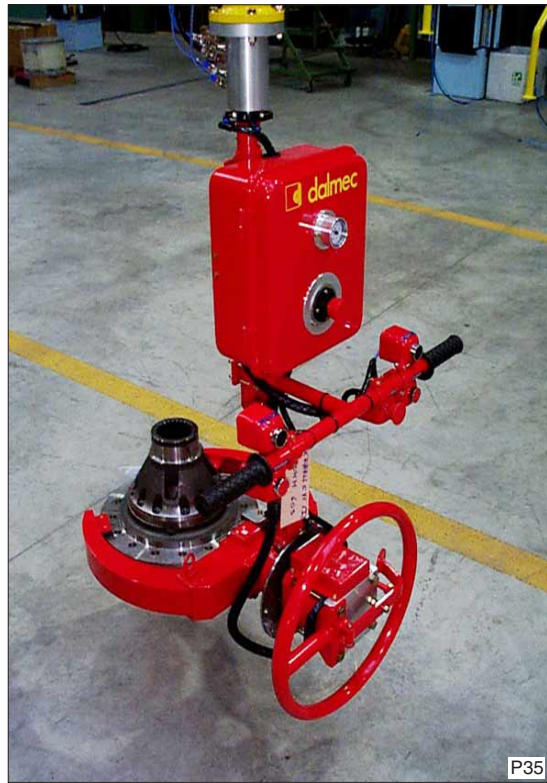
Zware haren opnemen met een speciale lastopnemer. De naaf kan 180° gedraaid worden, daardoor is hij eenvoudig in en uit de bewerkingsmachine te nemen.
