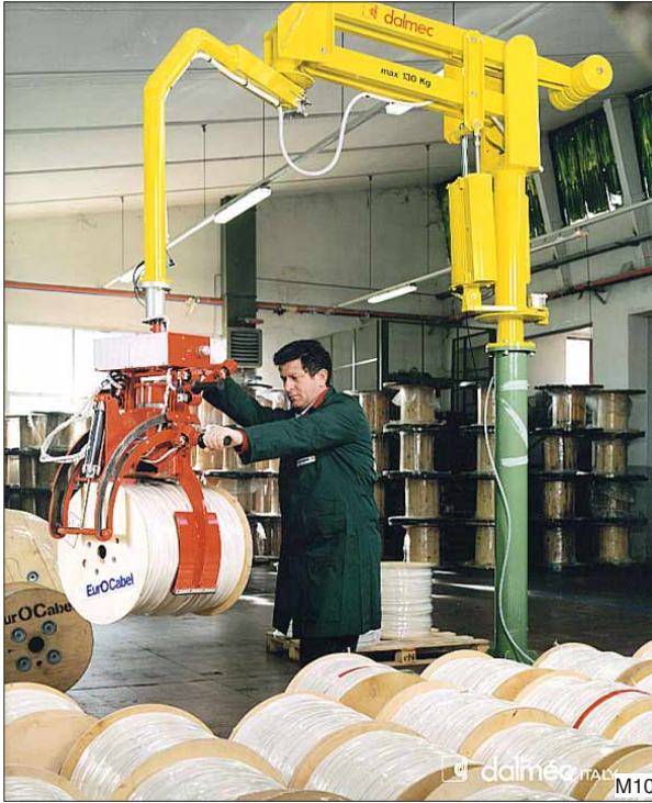
Partner balancer in kolomuitvoering voor het opnemen en 90° kantelen van houten haspels. De lastopnemer klemt de haspels pneumatisch. Het verlichten van zwaar en onaangenaam werk met een optimalisering van kwaliteit en efficiency: geen beschadigingen van de haspels bij het kantelen of palletiseren.
