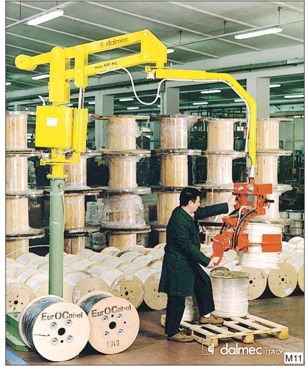
Partner balancer in kolomuitvoering voor het opnemen en 90° kantelen van houten haspels. De lastopnemer klemt de haspels pneumatisch. Het verlichten van zwaar en onaangenaam werk met een optimalisering van kwaliteit en efficiency: geen beschadigingen van de haspels bij het kantelen of palletiseren.
