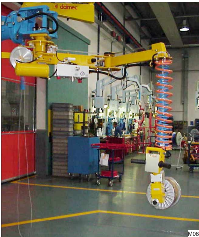
Deze extra speciale balancer 'de Speedyfil' in hangend verrijdbare uitvoering is voorzien van een lastopnemer, die de spoelen volledig automatisch klemt en na kantelen en wegzetten ook automatisch lost. Zonder bedieningsknoppen. Eenvoudig en snel.
