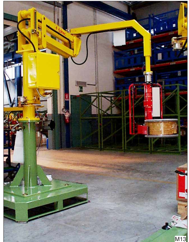
Een verplaatsbare voetplaat volgens het 'transpallet-type'. Behalve met een vorkheftruck is de balancer ook met een handpallettruck te verplaatsen. Het geheel wordt daarmee multifunctioneel en flexibel inzetbaar.
