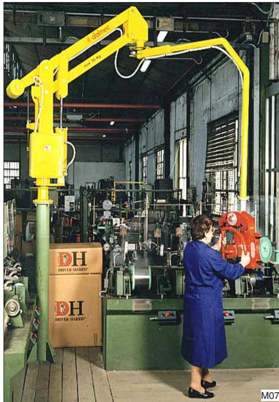
Partner balancer in kolomuitvoering met pneumatisch werkende lastopnemer voor het opnemen en handmatig draaien van spoelen.
