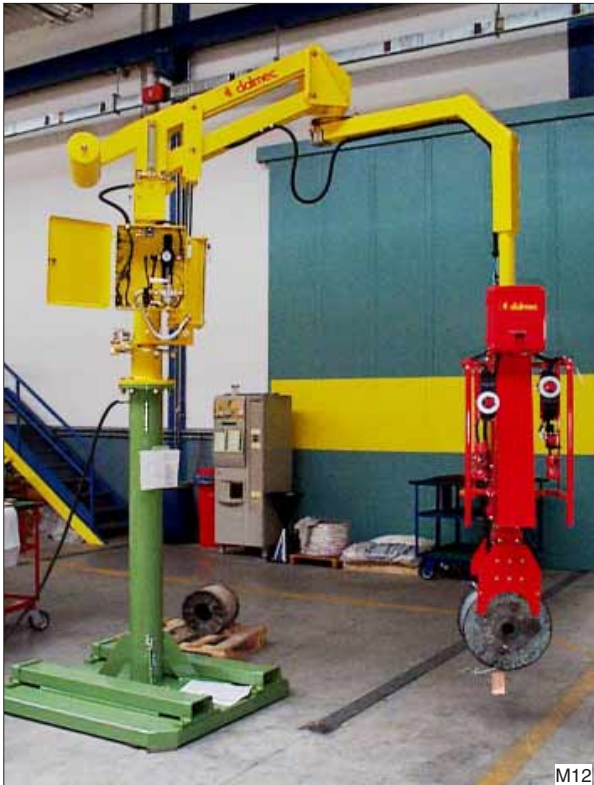
Deze Partner balancer is gemonteerd op een verplaatsbare voetplaat die vaste montage aan de vloer overbodig maakt. De balancer is met behulp van een vorkheftruck op te nemen en te verplaatsen.
