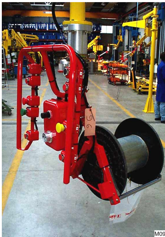
Twee vorken voor het opnemen van spoelen. Een ingebouwde sensor zorgt voor een veilige handling: pas als de spoel goed op de vorken gepositioneerd is kan hij opgenomen worden.
