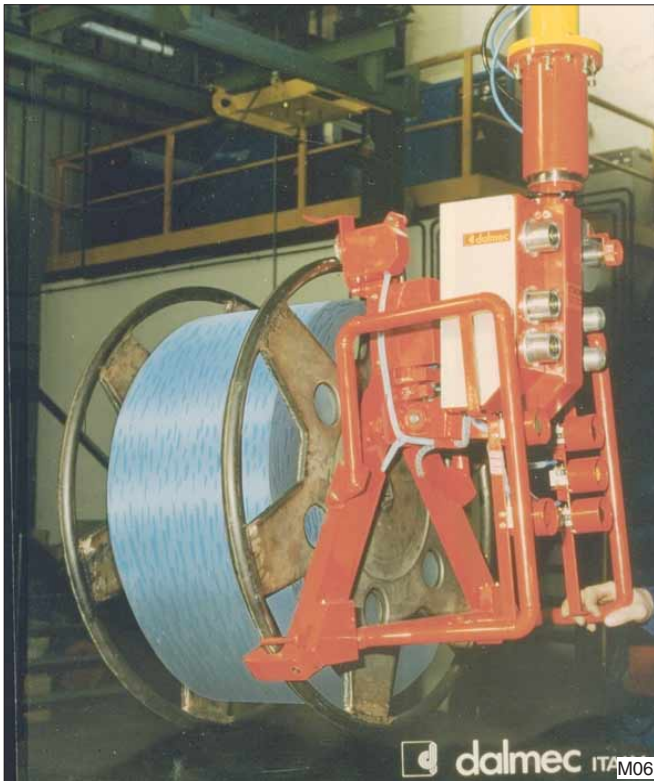
Ook zware stalen spoelen veilig opnemen en 90° kantelen. Klemmen en kantelen gebeurt pneumatisch met ingebouwde cilinders.
