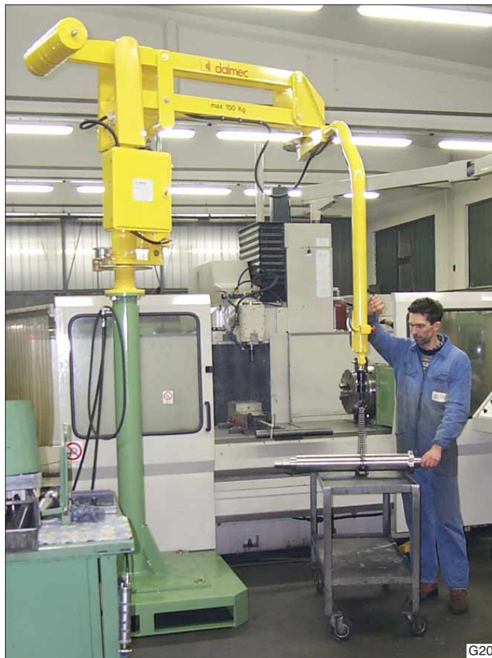
Dalmec Partner balancer, type PRC, in kolomuitvoering met verplaatsbare voetplaat. Vaste montage aan de vloer wordt hiermee overbodig.
