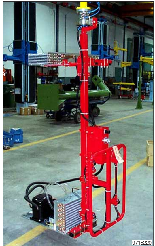
De lastopnemer van deze balancer schuift onder het product en kan zo een groep onderdelen van de koelkast opnemen, verplaatsen en plaatsen in de koelkast.
