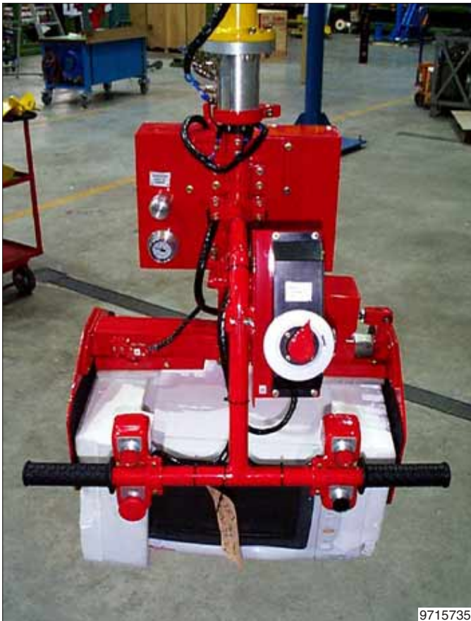
Lastopnemer waarmee een magnetron klemmend aan de zijkanten opgenomen en verplaatst wordt.
