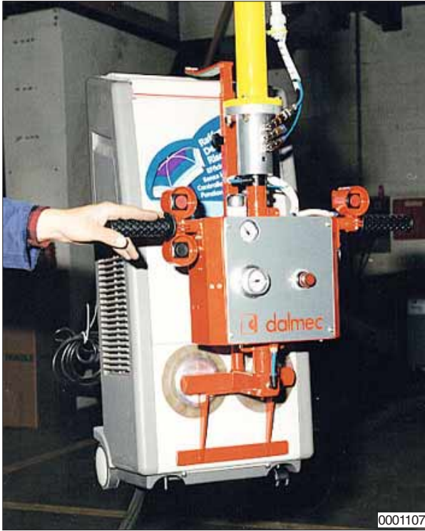
Met twee zuigschalen een airconditioner opnemen.
