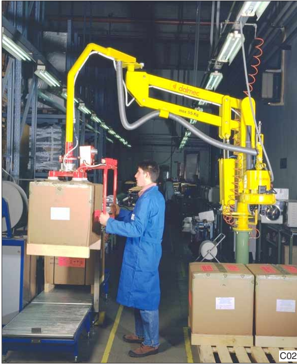
Snel, eenvoudig en uiterst licht opnemen van dozen van een rollenbaan en op een gereedstaande pallet plaatsen. Meer inhoud geven aan zwaar en onaangenaam werk met de Dalmeccanica Partner balancer.
