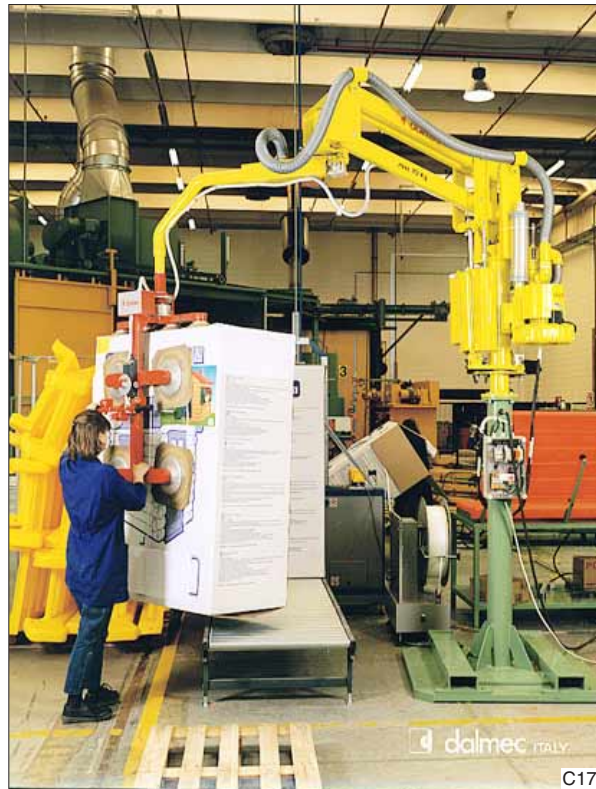
Behalve het gewicht kan ook de vorm van de doos doorslaggevend zijn voor het inzetten van een Dalmec Partner balancer.
