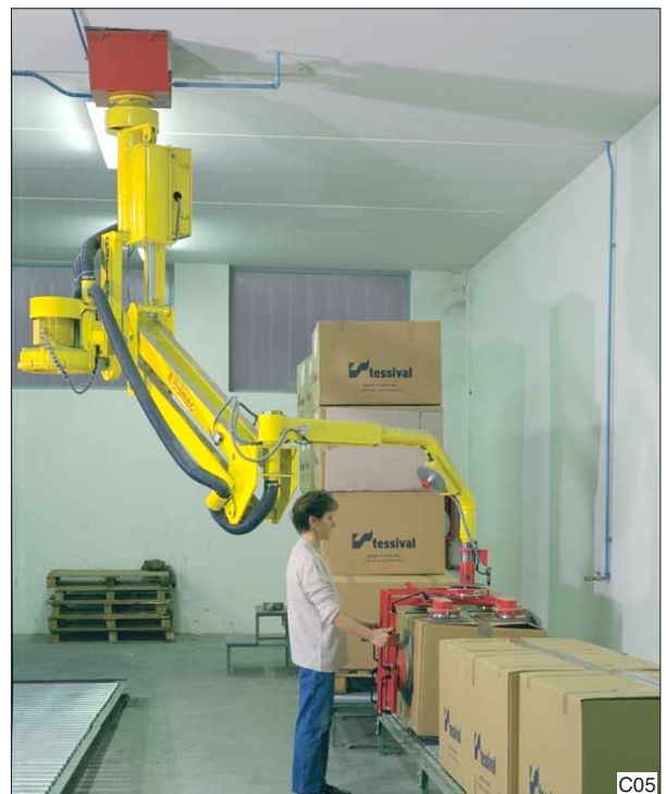
Het volledige vloeroppervlak blijft behouden wanneer het balancersysteem opgehangen wordt aan het plafond. Hier worden de dozen aan de bovenzijde en aan de zijkant aangezogen met vacuüm om een minimale vervorming van de doos te realiseren. Veilig en eenvoudig.
