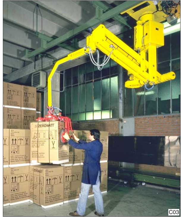
Opgehangen aan een lorrie in een railsysteem heeft de Dalmeccanica Partner balancer een extra groot werkbereik. De lorrie kan handmatig of pneumatisch voortbewogen worden.
