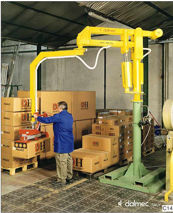
Het opnemen en omstapelen van dozen met een Dalmec Partner balancer. De verplaatsbare voetplaat maakt het mogelijk de balancer met een vorkheftruck te verplaatsen. Vaste montage aan de vloer wordt dan overbodig en de balancer is op meerdere plaatsen in het bedrijf inzetbaar.
