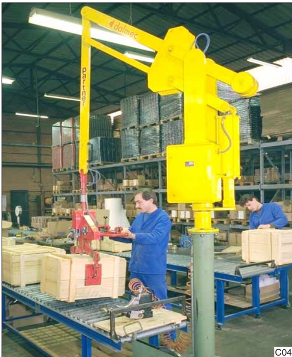
Het grote slagbereik van de pneumatisch werkende klem maakt het mogelijk een groot scala aan houten kratten met verschillende afmetingen te handelen.
