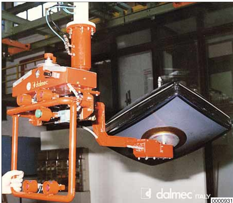
Lastopnemer met een speciale vacuüm-zuigschaal, gemonteerd aan een Partner balancer. Het draaien van de pallet gebeurt pneumatisch met een dubbelwerkende rotatiecilinder.
