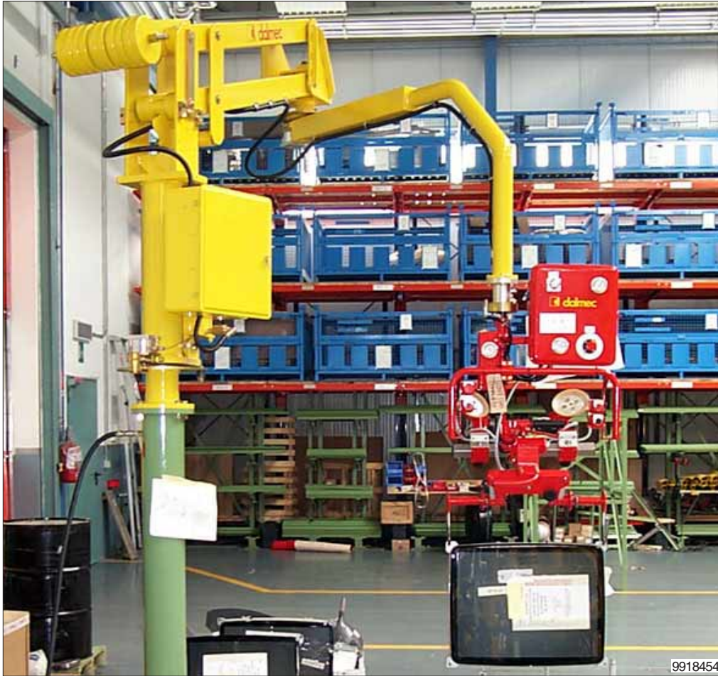
Dalmec Partner balancer in kolomuitvoering met een lastopnemer, die beeldbuizen met veel verschillende afmetingen op kan nemen.
