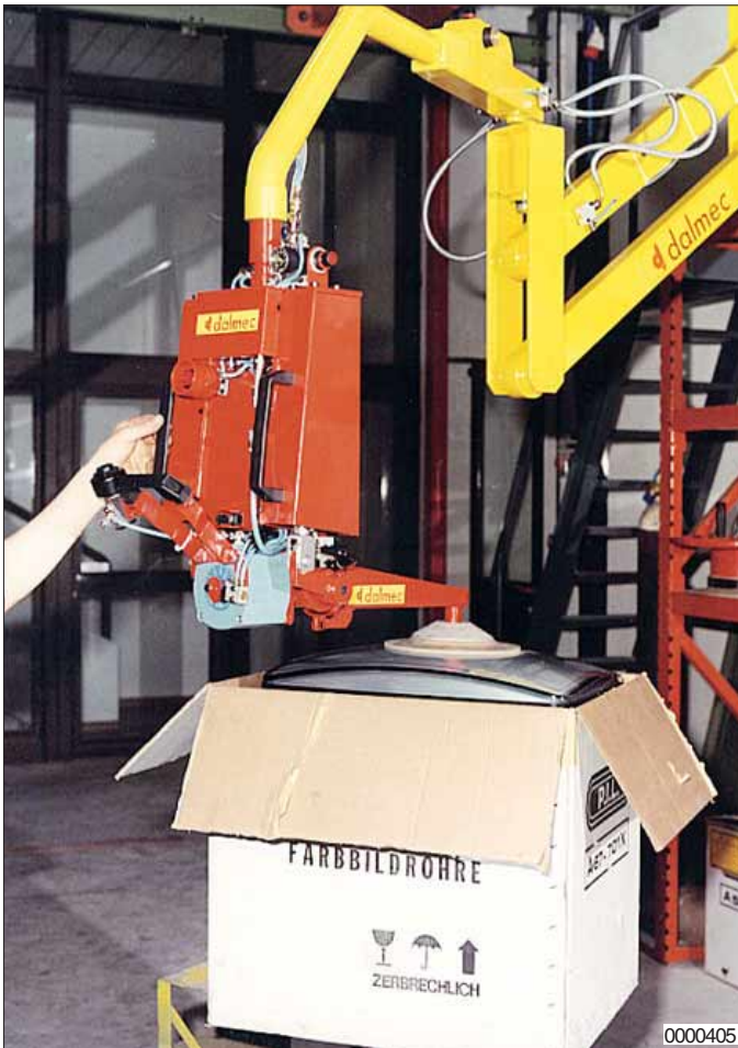
Een lastopnemer voor het opnemen, kantelen en 180° draaien van beeldbuizen, zodat ze in een testmachine geplaatst kunnen worden. Opname gebeurt door venturi-vacuüm.
