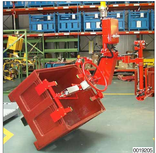
Bakken klemmen en kantelen met deze lastopnemer. De verschillende kratafmetingen kunnen eenvoudig en snel ingesteld worden.
