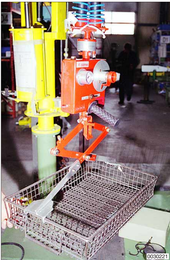
Een schaarklem gemonteerd aan het bedieningskastje van de Posifil balancer, waarmee stalen manden kunnen worden opgenomen en verplaatst.
