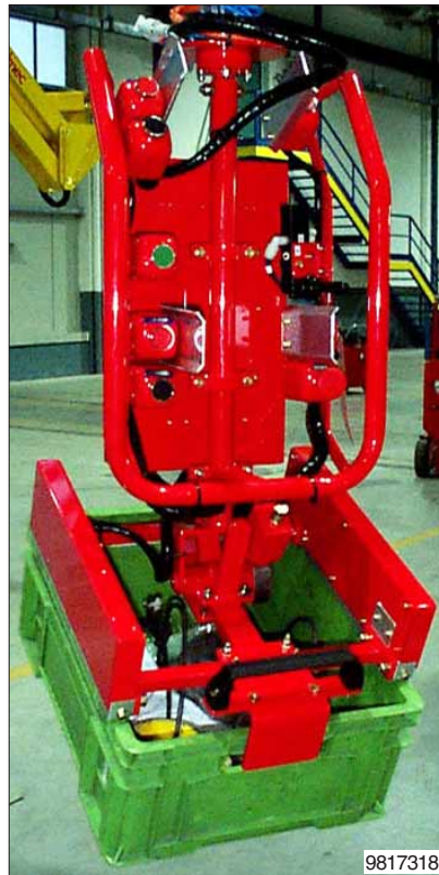
Kunststofbakken onder een hoek opnemen en horizontaal op een pallet plaatsen.
