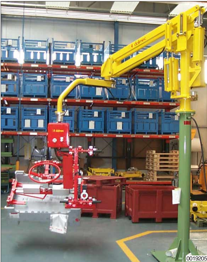
Dalmecc Partner balancer in kolomuitvoering, voorzien van een verplaatsbare voetplaat. Vaste montage aan de vloer is niet nodig
