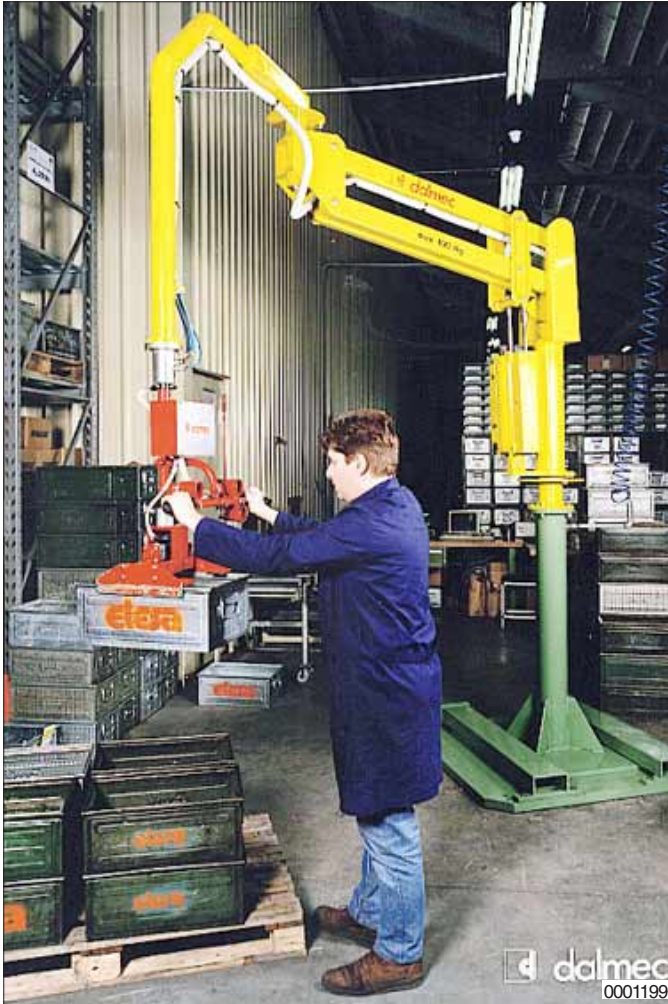
Dalmecc Partner balancer in kolomuitvoering, voorzien van een verplaatsbare voetplaat. Vaste montage aan de vloer is niet nodig
