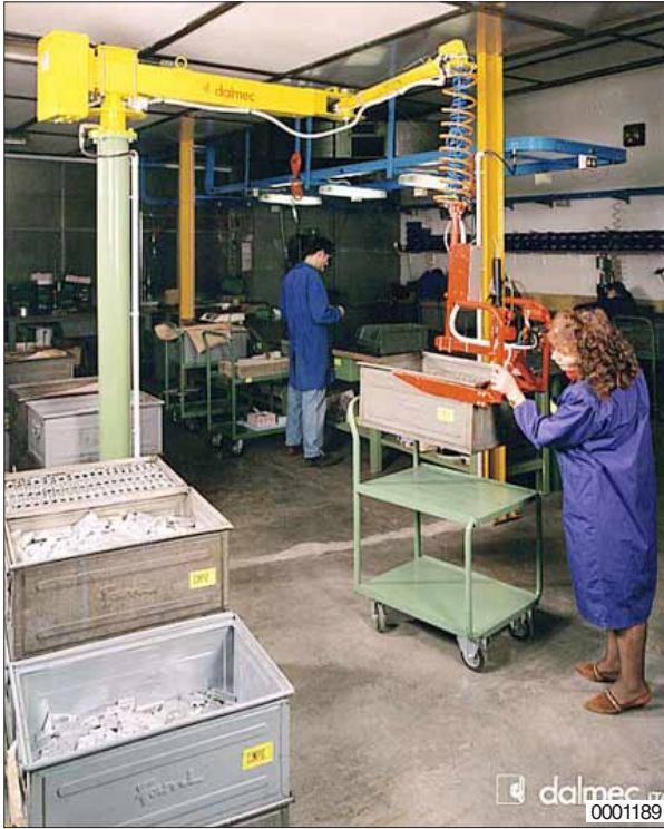
Deze Dalmecc Posifil balancer op kolom heeft als lastopnemer twee vorken, waarmee de krat dragend onder de rand wordt opgenomen en schijnbaar gewichtloos verplaatst.
