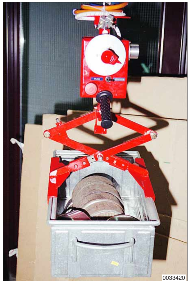
Een schaarklem gemonteerd aan het bedieningskastje van de Posifil balancer.
