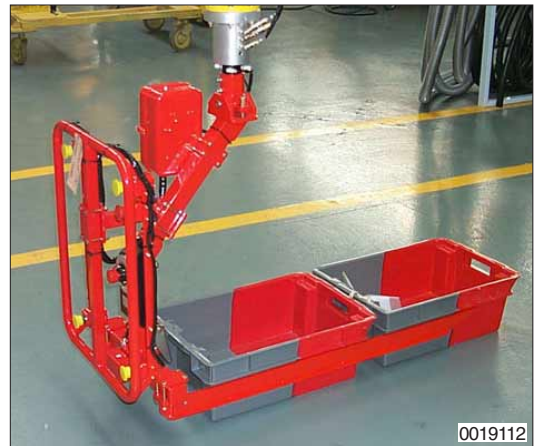
Twee bakken gelijktijdig opnemen met deze twee extra lange vorken.
